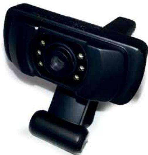
La detección y aviso por fatiga y distracción del conductor es el elemento más diferenciador con respecto a otros productos convencionales. Consiste en supervisar los parpadeos y movimientos de los ojos y la cabeza con el objetivo de detectar acciones anómalas que conducen a reacciones de riesgo por parte del conductor. En ese caso se activan las alarmas de aviso al conductor.
